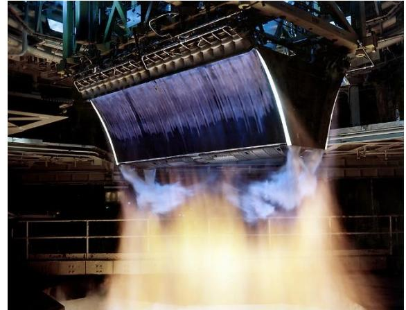
Pour un modèle simple de tuyère aerospike, l'écoulement est détendu de Mach 1 à un nombre de Mach  $M_2$  souhaité, en traversant un éventail de Prandtl-Meyer (figure ci-contre). Au point de fonctionnement, l'écoulement en sortie est dans le sens de la poussée (figure ci-contre).
