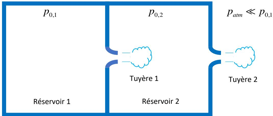
Le premier réservoir (très grand) est maintenu à une pression (de réservoir)  $p_{0,1}$  et température  $T_{0,1}$  données.
